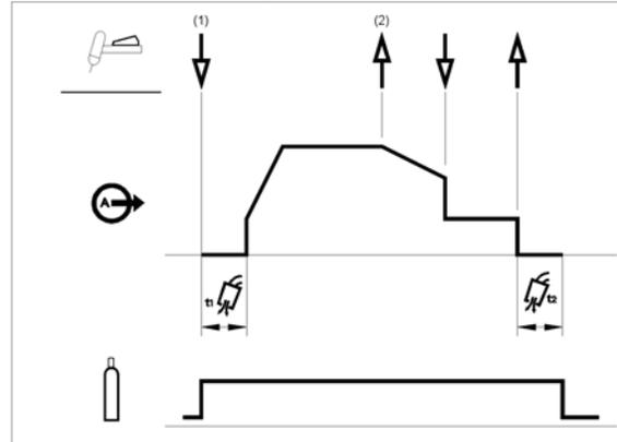
Como muestra la siguiente gráfica, si se pulsa y mantiene apretado el gatillo de la antorcha TIG por segunda vez durante la pendiente descendente, finalizará la pendiente y la corriente de salida se mantendrá con el valor de la corriente de cráter. Si se suelta el gatillo, la salida se apagará y comenzará el tiempo del postflujo de gas. Esta secuencia de funcionamiento de 2T con reinicio desactivado es el ajuste predefinido en fábrica.
