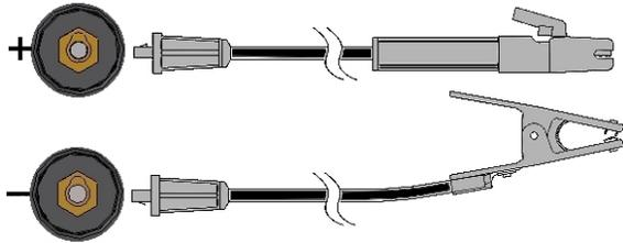
Conecte el cable de pinza al conector de salida (+) y el cable de masa al conector de salida (-). Inserte el enchufe con la guía alineada con la ranura y gire aproximadamente 1/4 de vuelta en el sentido de las agujas del reloj. No apriete en exceso.
