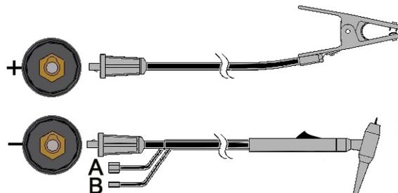
Conecte el cable de la antorcha al conector de salida (-) de la máquina y el cable de masa al conector (+). Inserte el enchufe con la guía alineada con la ranura y gire aproximadamente 1/4 de vuelta en el sentido de las agujas del reloj. No apriete en exceso.
