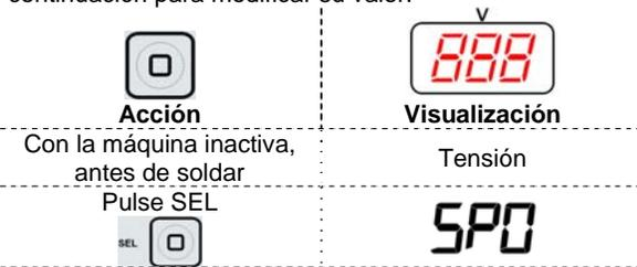
En esta etapa el tiempo de punto se debe ajustar girando la mando de ajuste de la corriente de salida. Si el tiempo de punto se ajusta en "0", la función de tiempo fijo se desactivará y el control del tiempo pasará a depender del gatillo de la antorcha TIG.
