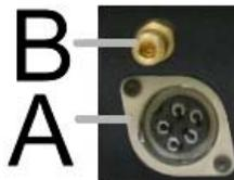
conectar la manguera al frente de ésta. A continuación, conecte una manguera entre el conector de gas en la parte posterior de la máquina y el regulador de gas instalado en el cilindro del gas empleado. Los ajustes necesarios están incluidos en el package. Conecte el cable del gatillo de la antorcha al conector (A) ubicado en el frente de la máquina.
